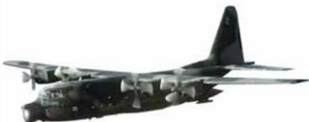
MC-130은 C-130 험클리즈의 특수전형으로 MC-130E 컴뱃 탤런 I/MC-130H 컴뱃 탤런 II는 특수부대 수송형이며 MC-130P는 구조 및 회수형으로 MC-130E와 MC-130P는 특수전 헬리콥터 (페이브로우시리즈)에 공중급유를 할 수 있다.
